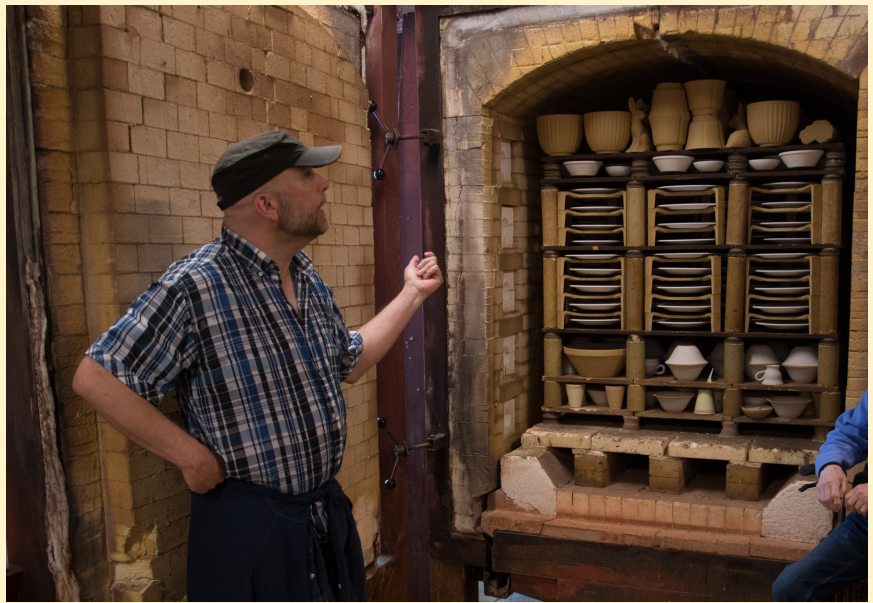
De elektriska ugnarna ersattes 1972 av denna gasoldrivena ugn
