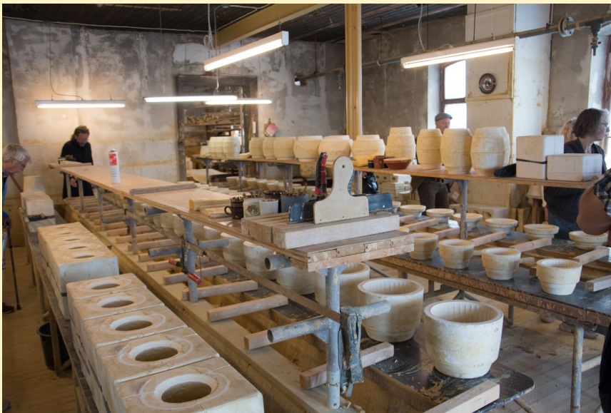
Till denna avdelning kommer leran i rörledning för att fyllas i formar
